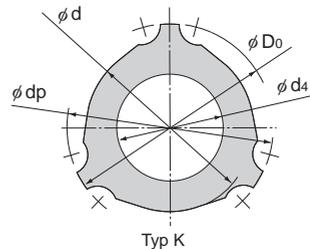
Tab. 3 Querschnitte der hohlen Standard-Keilwellen
